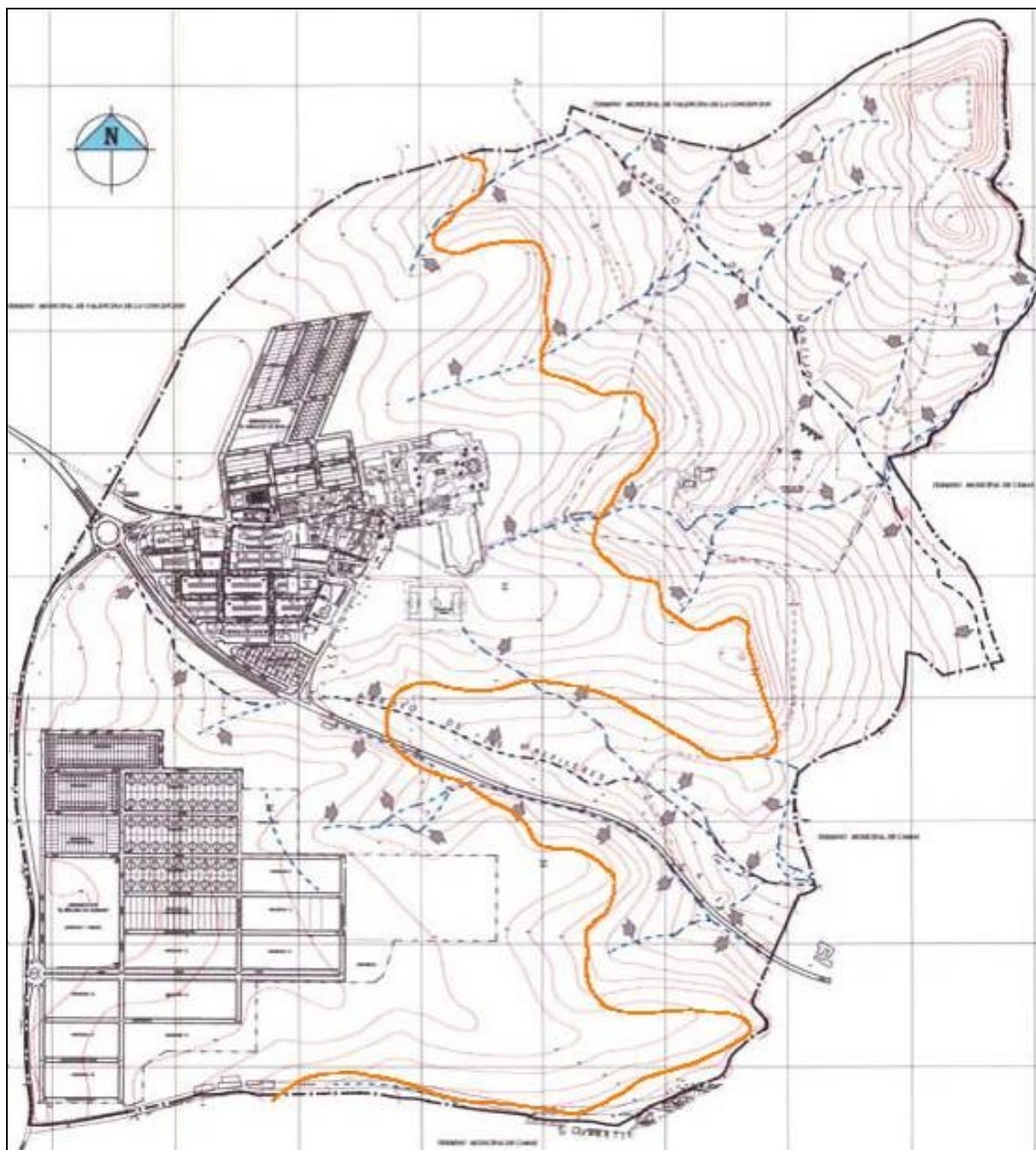
Imagen 05/04 - Plano topográfico con línea de estabilidad geomorfológica
